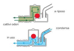
First Box: cassetta per scarico condensa reversibile destro o sinistro. Raccordo per attacco tubo Ø 16-18 e Ø 18-20 mm. Completo di O-ring
