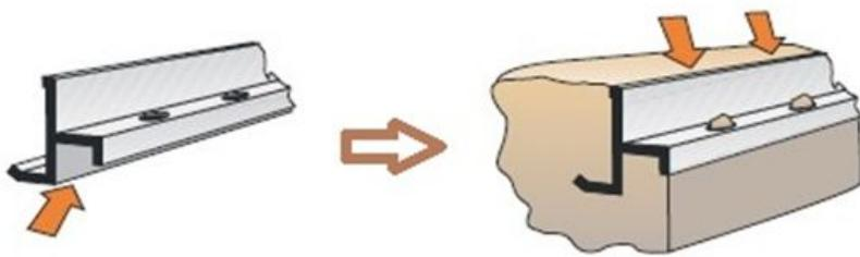
Il profilo non è autoportante; lo diventa con una corretta applicazione: riempimento totale con calcestruzzo della parte inferiore del telaio. A tale scopo si consiglia di effettuare alcuni fori lungo il piano di appoggio per assicurarsi dell'avvenuto riempimento.
