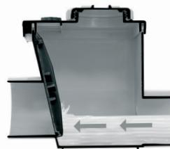
Le valvole di non ritorno Idrostop, disponibili in versione ad incollaggio o con guarnizione, sono dispositivi di anti-allagamento che si chiudono automaticamente quando si verifica un riflusso e consentono lo scarico normale quando il riflusso cessa. L'installazione è possibile in sistemi di scarico di acque reflue funzionanti a gravità, all'interno ed esterno degli edifici ad uso pubblico, residenziale, commerciale, industriale.
