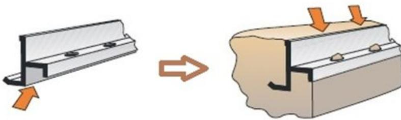
Il profilo non è autoportante; lo diventa con una corretta applicazione: riempimento totale con calcestruzzo della parte inferiore del telaio. A tale scopo si consiglia di effettuare alcuni fori lungo il piano di appoggio per assicurarsi dell'avenuto riempimento.
