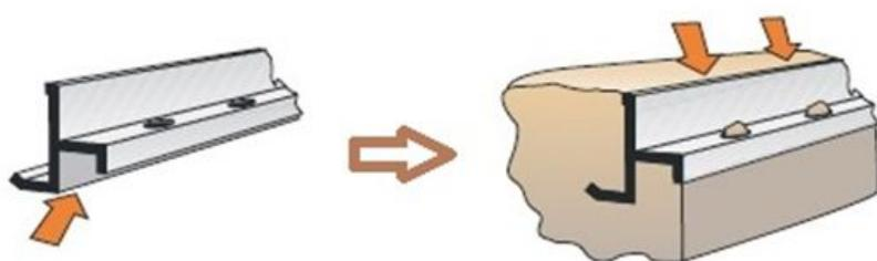
Le profilé n'est pas autoportant ; il le devient lorsqu'il est correctement posé : remplir entièrement de béton la partie inférieure du cadre. À cette fin, il est conseillé de percer quelques trous le long de la surface d'appui afin de s'assurer que le remplissage est bien effectué.
